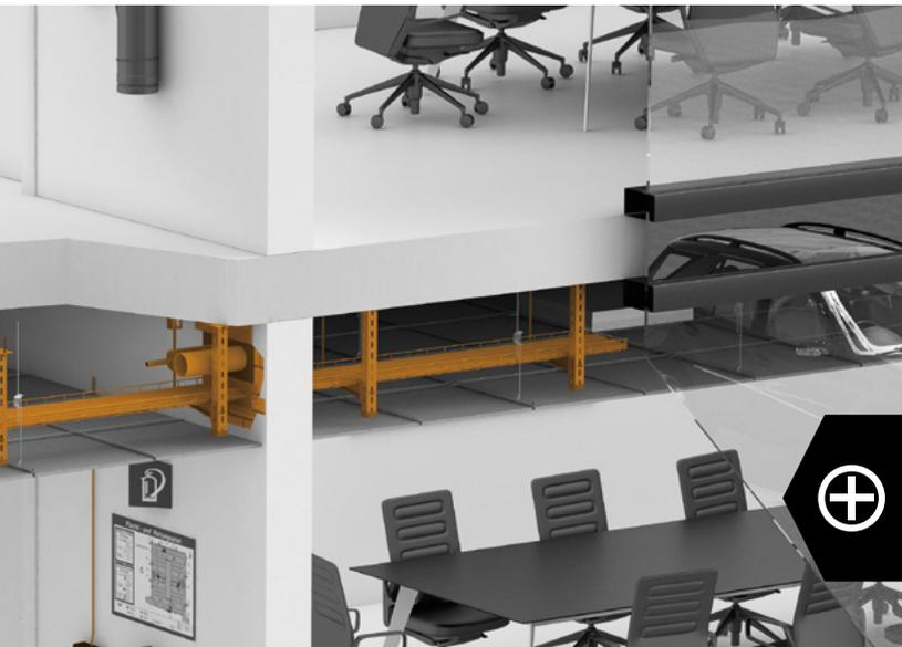
Bei Installationen oberhalb von abgehängten Brandschutzdecken ist besondere Vorsicht geboten: Die Decke darf im Brandfall keinesfalls von herabfallenden oder sich verformenden Teilen belastet oder beschädigt werden. Hier eingesetzte Kabeltragsysteme müssen brandsicher ausgelegt sein und eine große Auswahl bieten, um sich optimal an das zu verlegende Kabelvolumen und den verfügbaren Installationsraum anzupassen.
