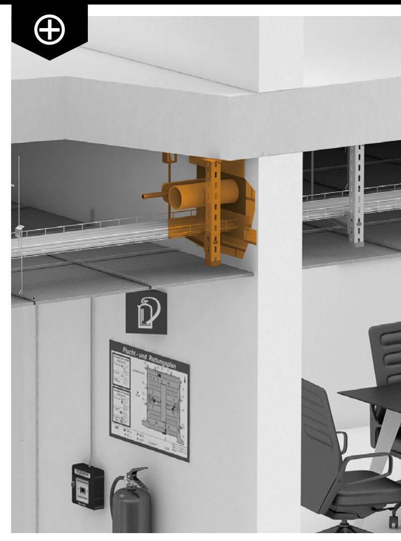
Ein sensibler Bereich, der gerne vergessen wird: Die Leitungen im Unterflurbereich. Doch auch unterhalb des Systembodens muss gut abgeschottet werden. In Serverräumen mit Systemböden bieten sich staub- und faserfreie Systeme an, da hier auf Sauberkeit sehr viel Wert gelegt wird.
